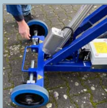
Nastavitelná šířka pro větší stabilitu
