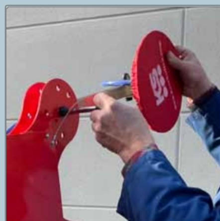
Flexibilní přísavné talíře pro různé formáty skla
