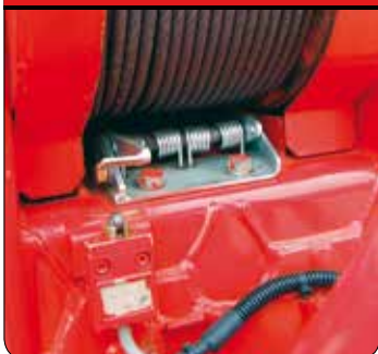
Snímač odmotání lana na bubnu
