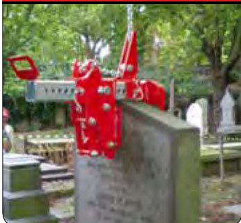
Robotické ocelové kleště (SWL:750kg)
