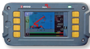
Plnohodnotný indikátor bezpečného zatížení
