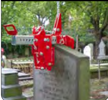
Robotické ocelové kleště (SWL:750kg)
